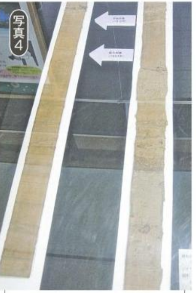
一ノ目瀧の年縞堆積物標本(長さ84センチ、幅6センチ)。明暗の縞(しま)模様一対が1年分の堆積物に当たる。分析することで過去の気候変動や火山活動、地震の記録などが分かる
